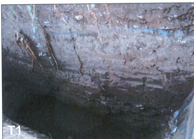
Foto 4 Trincea T1: particolare sezione scavo (profondità dal piano campagna = circa 3 m).
